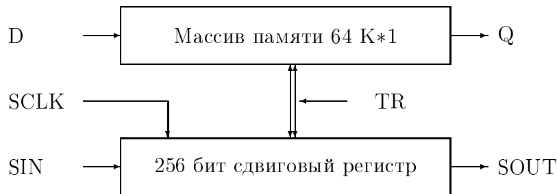
Рис. 0.2.3: Структурная схема VRAM памяти
