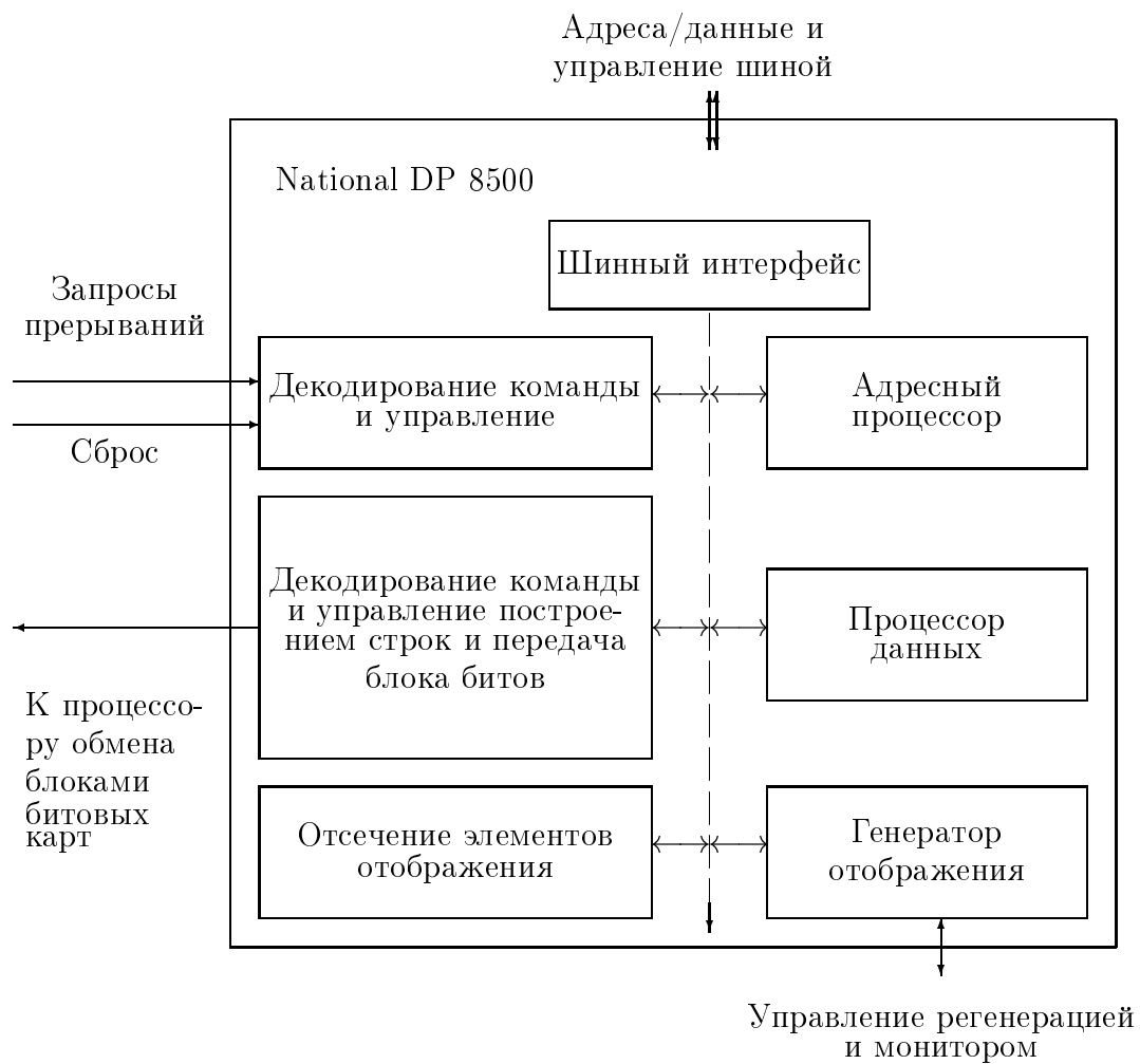
Рис. 0.2.11: Структурная схема растрового графического процессора DP-8500 фирмы National Semiconductor
