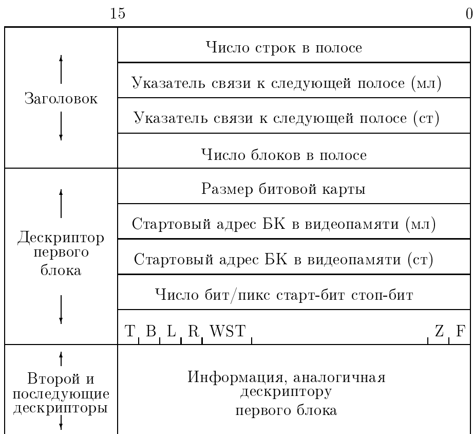
Рис. 0.2.10: Структура управляющего блока дескриптора оконного сегмента для i82786. T,B,L,R — управляющие биты для верхней, нижней, левой и правой границ; WST — статус окна; Z — увеличение; F — фоновое поле.
