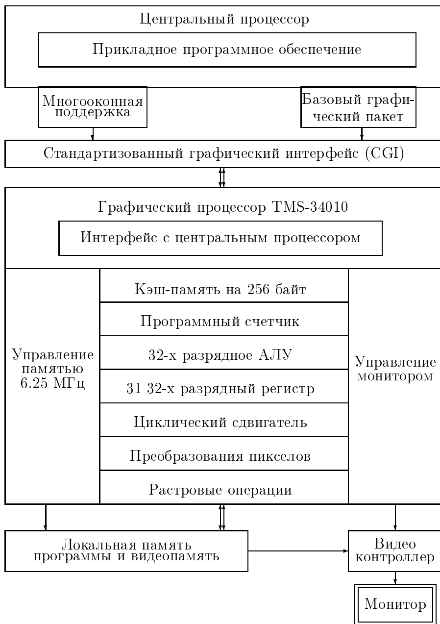
Рис. 0.2.6: Использование TMS-34010 в графической системе
